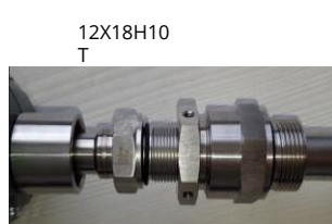
Присоединение к процессу (Поворотный узел для удобства монтажа)
